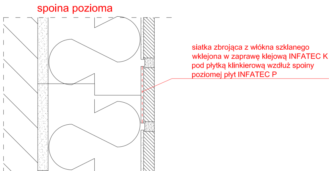
Rys. nr 79. Schemat wklejenia siatki zbrojącej z włókna szklanego w warstwę zaprawy klejowej wzdłuż spoiny poziomej płyt INFATEC P (wzmocnienie podłoża pod płytkę klinkierową klejoną na złączu poziomym płyt styropianowych).
